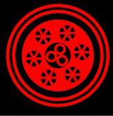
垫层。最小厚度为0.3毫米，最大为500欧姆的电阻率，在90°C的米屏蔽是紧密安装在绝缘排除所有空气空隙，可以很容易地在现场用手剥离。
