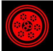
三芯 3.6/6KV (Um=7.2KV) 镀锌扁平钢丝铠装+钢带铠装
