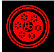
三芯 18/30KV (Um=36KV) 镀锌扁平钢丝铠装线缆
