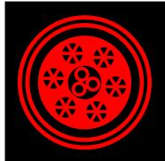
三芯 12/20KV (Um=24KV) 镀锌扁平钢丝铠装线缆
